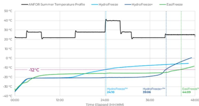
Gefrorene thermische Leistung von EasiFreeze im Vergleich zu HydroFreeze-Alternativen. Der Test wurde mit 3000 Gramm Kühlmittel, ohne Nutzlast und der PHARMA4 EPA-Box durchgeführt. Die vollständigen Testergebnisse sind auf Anfrage erhältlich.
